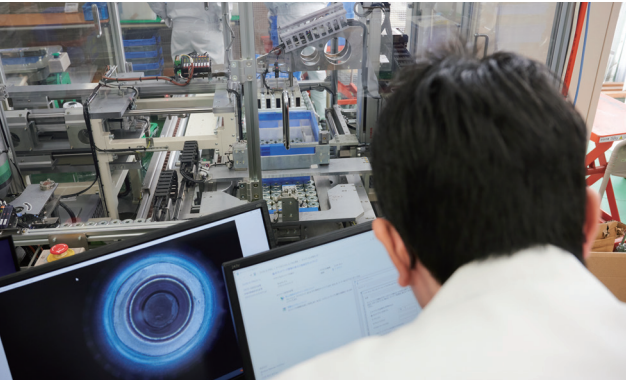
画像認識を使った不良品検出の様子
